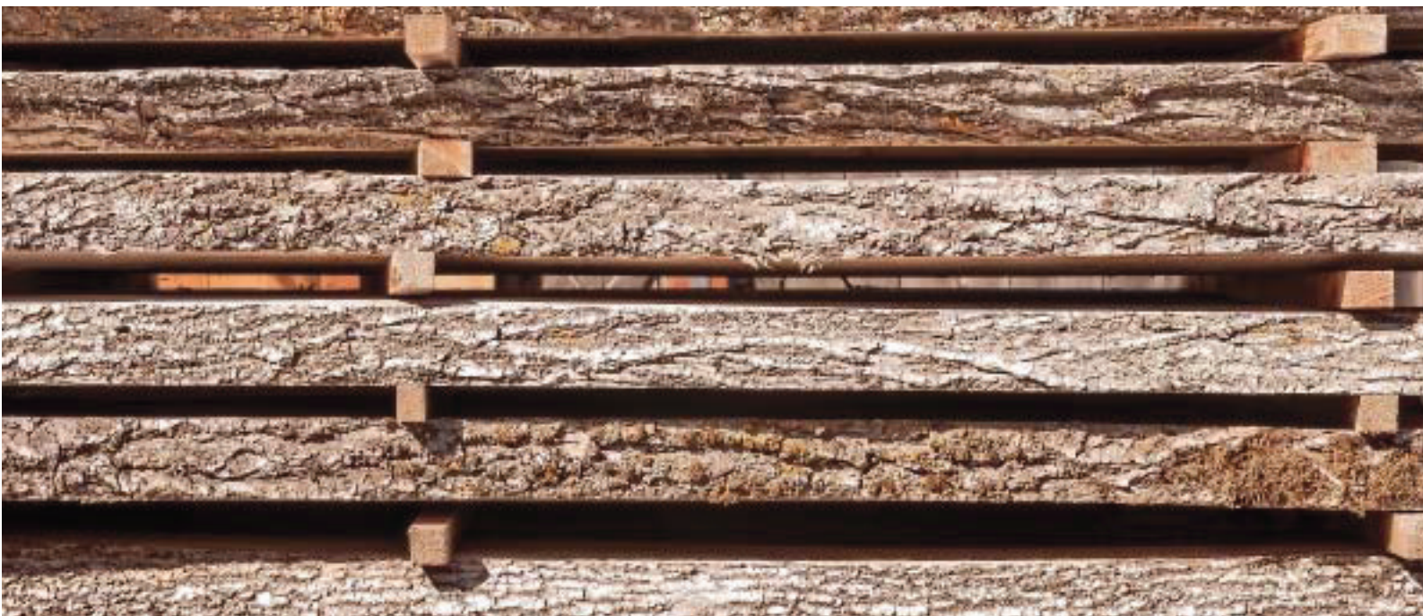
Sauber gestapelt steht das Holz auf dem Gleiswagen vor der Trockenkammer, die es von 18 auf 8 Prozent trocknen wird
