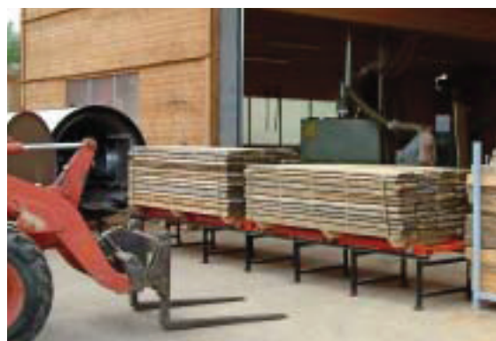
Vakuum trockner vor der Schreinerwerkstatt: Der Aufstellort will wegen des Fundaments gut überlegt sein
