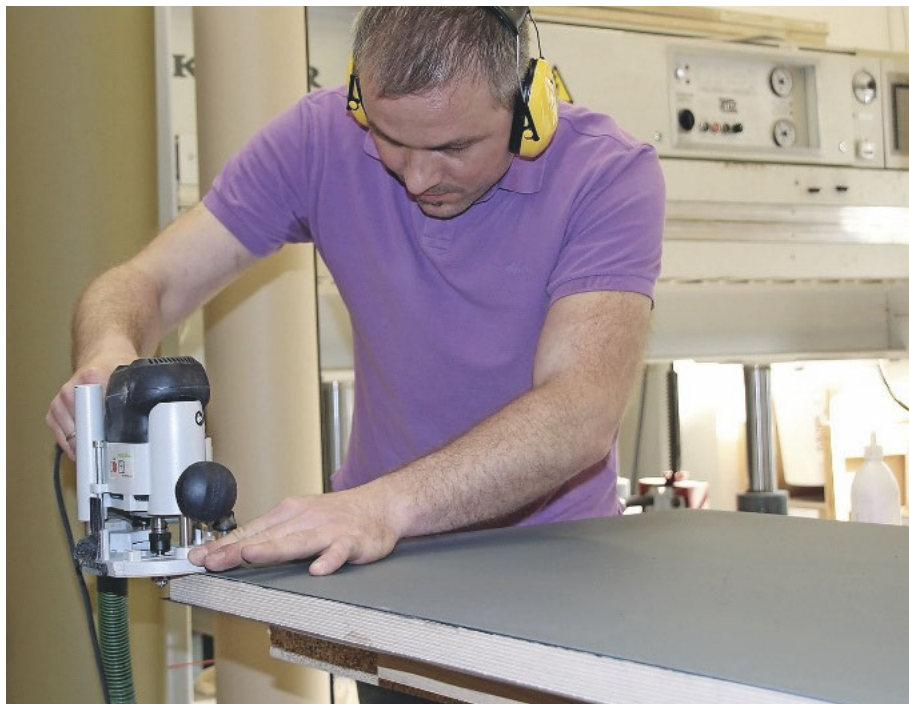
Ganz ohne Handarbeit gehts nicht: Bündigfräsen des Linoleums an einer Tischplatte
