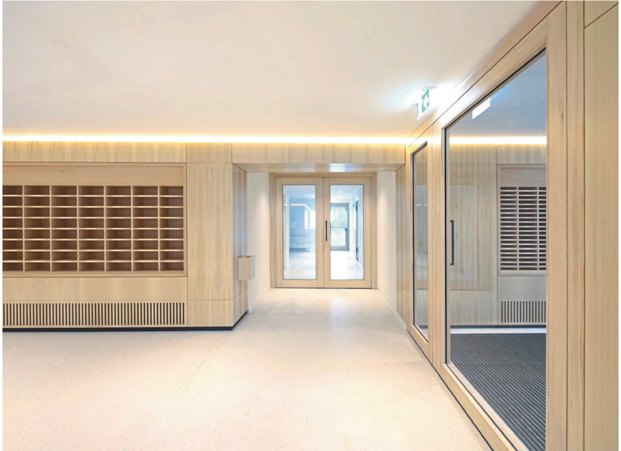
In Fortsetzung der Postfächer im Windfang integriert das Einbaumöbel im Foyer offene Fächer für Chormappen und eine flächenbündige Heizkörperverkleidung
