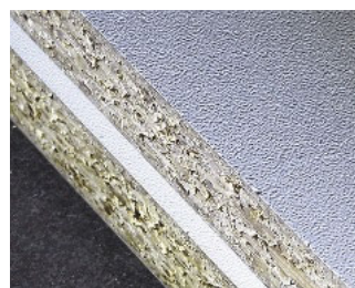
Mit melaminbeschichteten Spanplatten tun sich beide Sägeblätter schwer. Die Schnittunterseiten zeigen es: oben Leuco, unten Leitz
