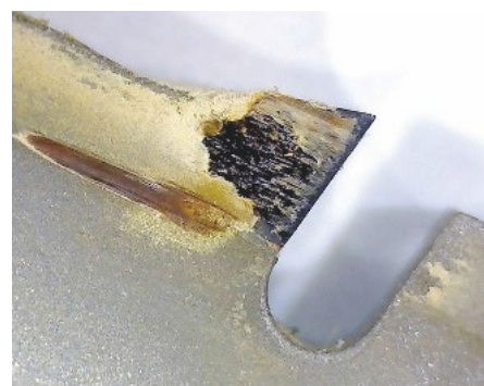
NN-Säge: auch hier deutliche Ablagerungen an der Nebenflechte – und am Stammblatt
