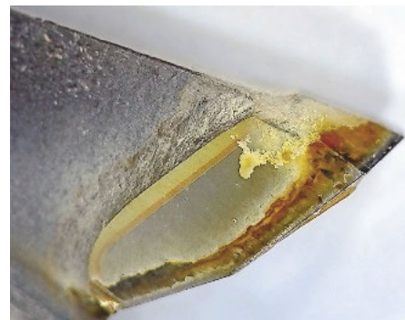
RazorCut: 200 m Sägeschnitt hinterlassen Spuren – doch nur an der Nebenflechte
