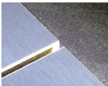
Mit der NN-Säge bearbeitet: je ein fühlbarer Grat an der Alu-HPL-Ober- und -Unterkante
