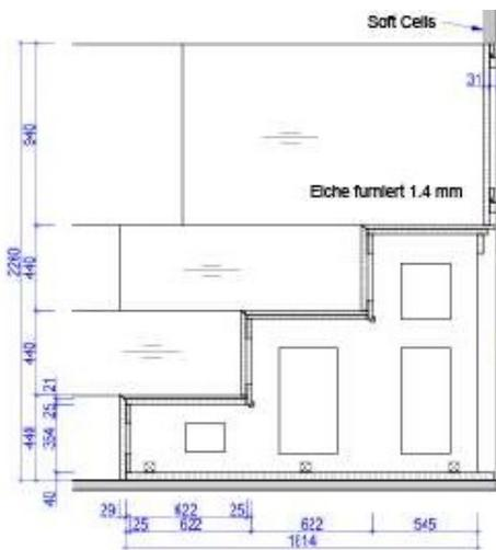
Vertikalschnitt der Sitzstufen
