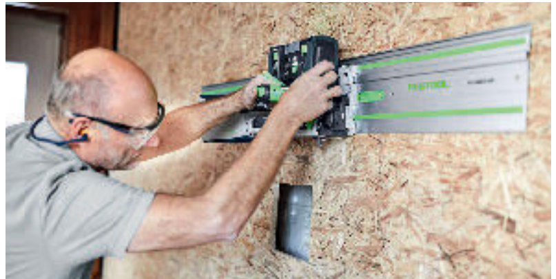
Mobil-vertical: Mit Klebepads kann die Schiene an der Wand fixiert werden
