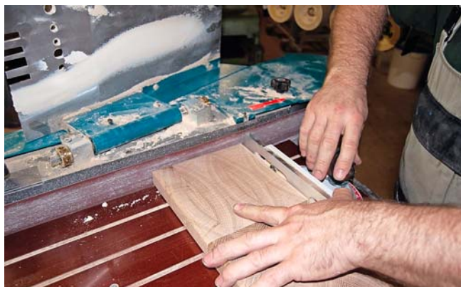
Die Kantenschleifmaschine säubert nicht nur, sie hilft auch, das Werkstück in Form oder auf das gewünschte Maß zu bringen
