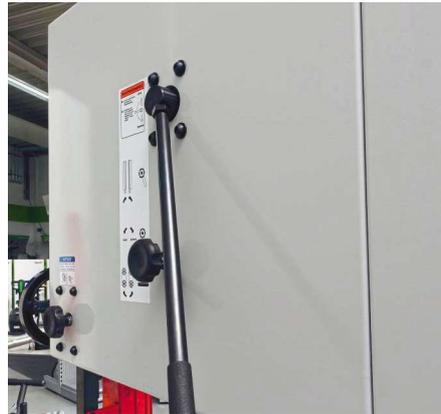
12 Hebel schwenken ... und das Sägeblatt ist entspannt/gespannt (Holzkraft)
