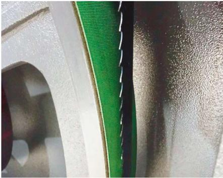
**8 Die Textilgummibandage hält werkzeuglos wechselbar im Konterprofil (Felder)**
